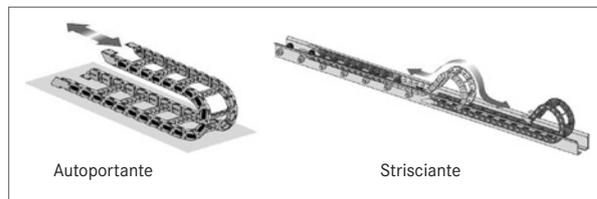
9. Nelle catene portacavi striscianti, nelle quali la parte superiore si ridistende e scorre sulla parte inferiore, il cavo deve essere fissato solo dalla parte del punto mobile. I cavi non devono in alcun caso essere soggetti a movimento vicino al punto di fissaggio.
